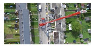
Les façades d'origine ont été reproduites numériquement, permettant de fabriquer en usine des façades de 40 cm d'épaisseur, apposées sur les maisons pour les isoler. Ces nouvelles façades permettent aux logements d'afficher un niveau A de Diagnostic de Performance Energétique (DPE), versus D ou E avant travaux.
