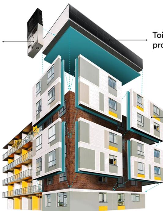
Toiture isolante avec production d'énergie
