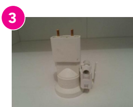
3 On se retrouve avec une douille et un domino
