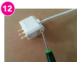
12 Bloquer le fil avec la petite vis en plastique sur le côté
