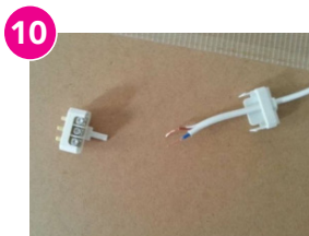
10 Passer le fil électrique dans la partie en plastique
