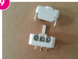
Les connecteurs du domino sont visibles
