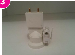
On se retrouve avec une douille et un domino
