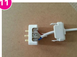
Visser les fils sur les extérieurs et la masse au milieu si besoin et reclipser les 2 parties ensemble
