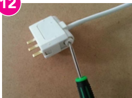
Bloquer le fil avec la petite vis en plastique sur le côté
